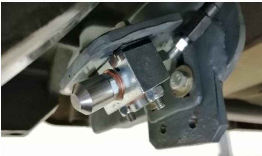
Sprühdüse zur Konditionierung der Lauffläche- oder des Schienenkopfs
