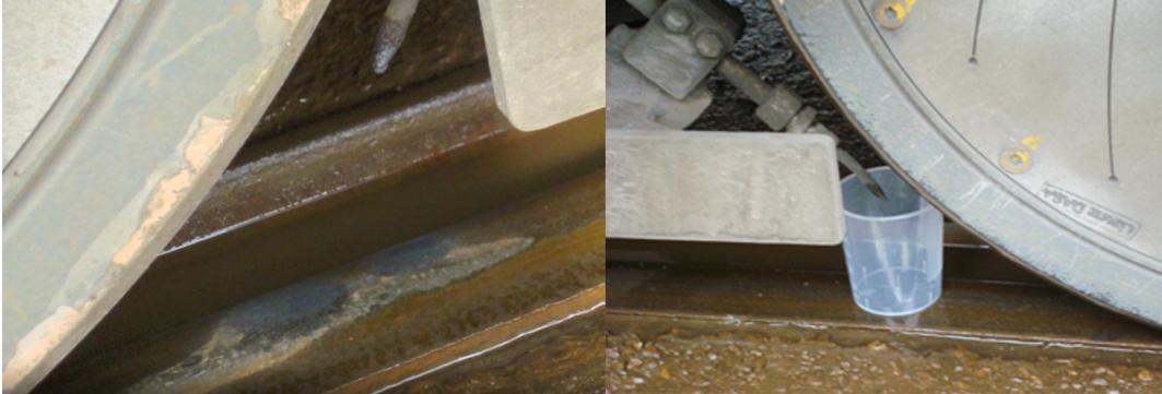
Mesurage de la masse déposée sur le champignon de rail
