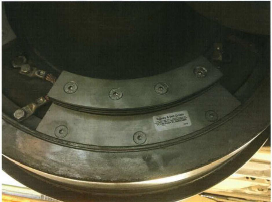
Abb. 2: Radabsorber als schallreduzierende Maßnahme direkt am Fahrzeug.
