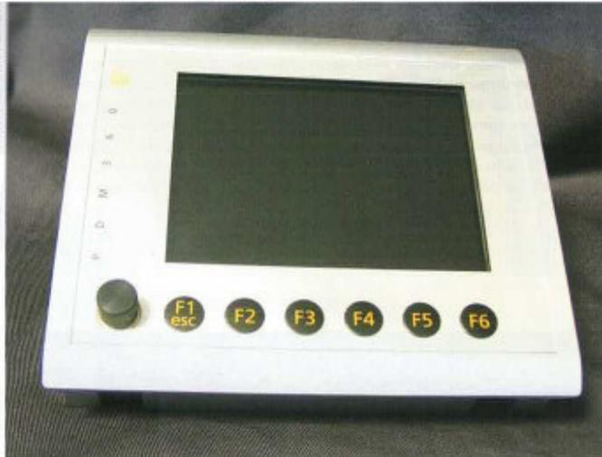
Abb. 3: Bediengerät zur GPS-gesteuerten Schmiermittelausbringung.
