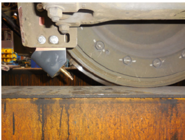
Bild: eine Düse appliziert eine Dosis vom Schmierstoff. Eine diskrete, aber anscheinend effiziente Installation.
